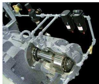
Подшипник вала в сборе и герметичное уплотнение насоса типа M
